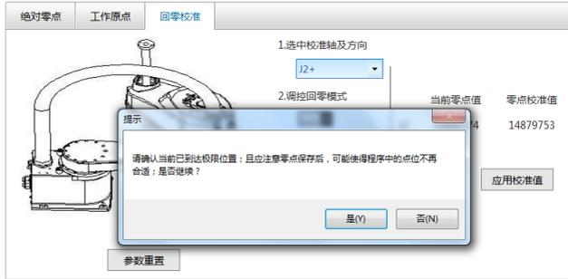
b. 单击“是”，确认更新零点，同时“零点校准值”替代当前零点。
