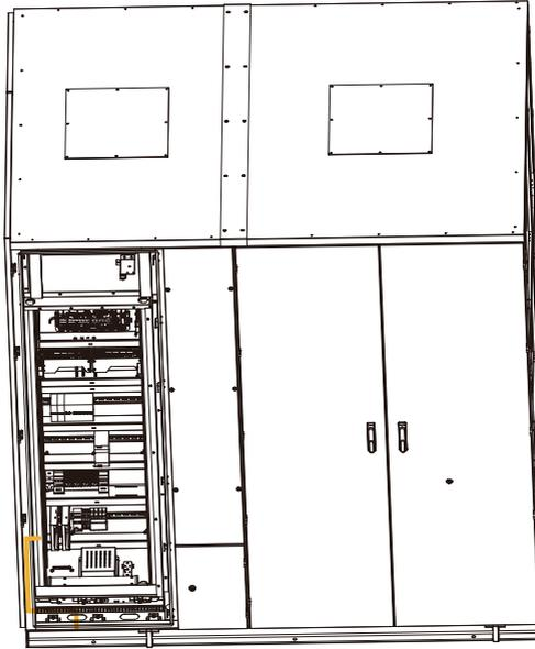
图3-18 同步电压控制信号电缆进线示意图
